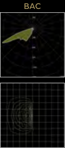
Ottica asimmetrica emissione molto larga Con illuminazione sotto palo Tecnica di illuminazione asimmetrica Asymmetric optic very wide emission With under-pole lighting Asymmetric lighting technique
