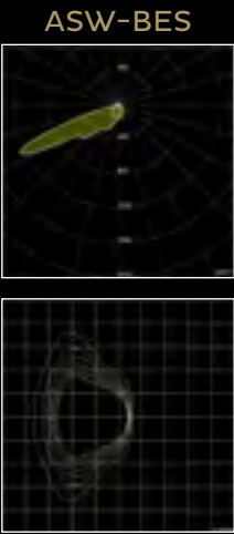
Ottica asimmetrica emissione larga Con illuminazione sotto palo Tecnica di illuminazione asimmetrica Asymmetric optic wide emission With under-pole lighting Asymmetric lighting technique
