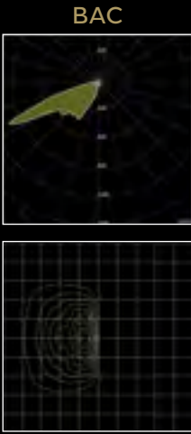
Ottica asimmetrica Utilizzo posizione centrale Tecnica di illuminazione B-Asymmetric Asymmetric optic Use central position B-Asymmetric lighting technique
