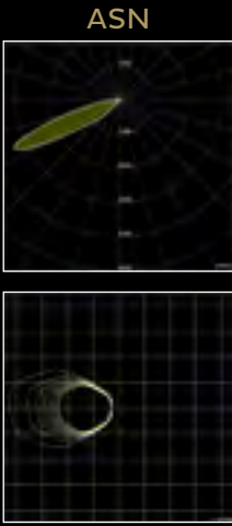
Ottica asimmetrica emissione stretta Priva di illuminazione sotto palo Tecnica di illuminazione asimmetrica Asymmetric optic narrow emission Without under-pole lighting Asymmetric lighting technique
