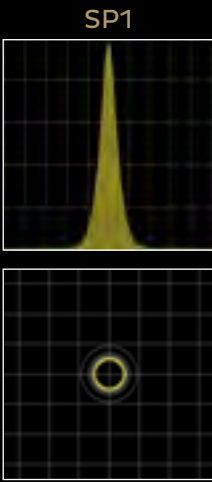
Ottica simmetrica spot Picco di intensità 16000 cd/Klm Tecnica di illuminazione puntuale Symmetric spot optic Peak intensity 16000 cd/Klm Spot lighting technique
